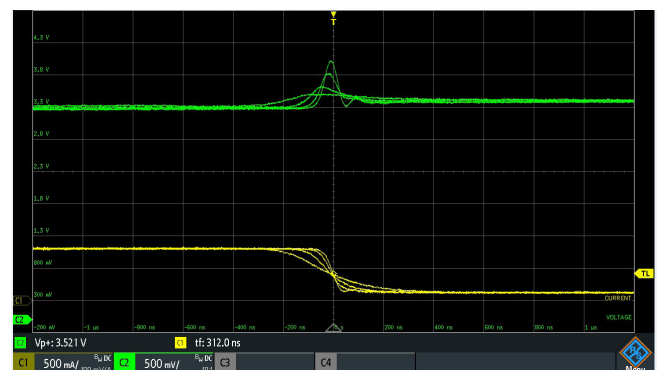
Rysunek 7. Oscylogram pokazujący moment odłączenia obciążenia dla różnych stromości impulsu prądowego
