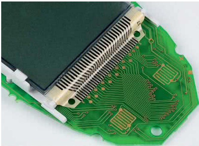
Fotografia 6. Zastosowanie kleju elektroprzewodzącego do montażu połączeń wyświetlacza
