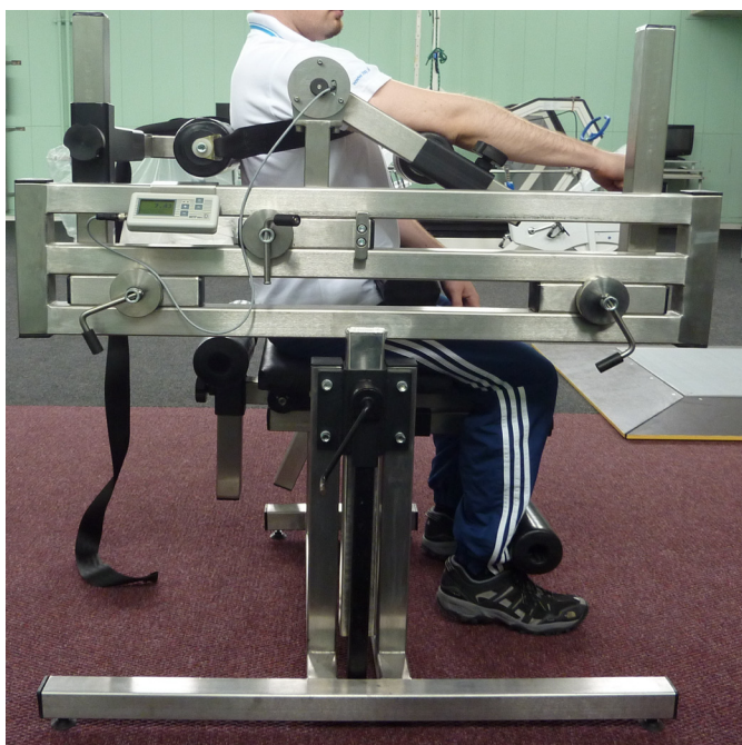
Fotografia 14. Stanowisko do badania momentów sił zginaczy i prostowników kończyn górnych
