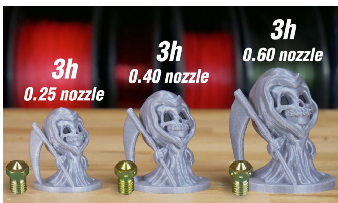
Fotografia 21. Porównanie dysz o różnej średnicy i wydruków wykonanych przy ich użyciu
