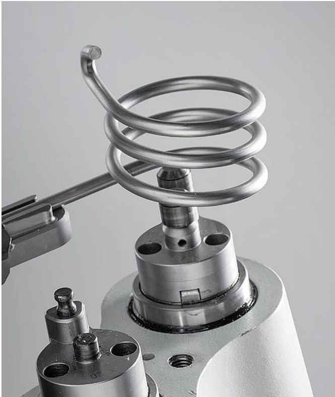
Fotografia 4. Element wykonany przy użyciu giętarki do drutu
