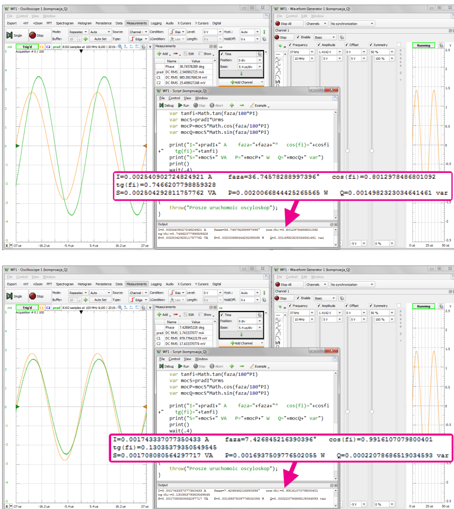
Rysunek 13. Wyniki pomiarów w programie WaveForms z użyciem Analog Discovery 2, a) układ bez kompensacji, b) układ z kompensacją
