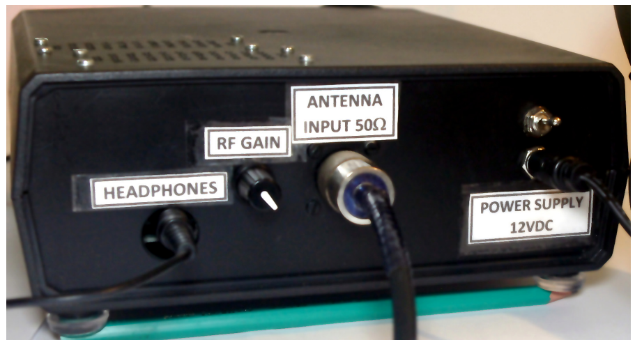
Fotografia 5. Aranzacja i opis tylnego panelu odbiornika
