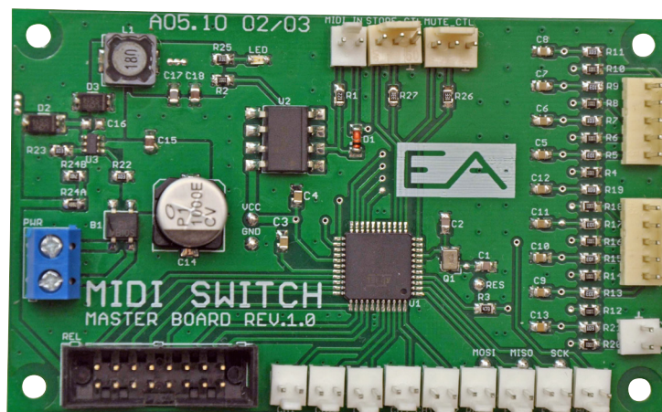
Fotografia 10. Widok zamontowanego obwodu drukowanego modułu sterującego
