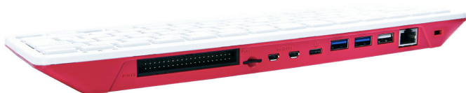
Fotografia 3. Wszystkie złącza Raspberry Pi 400 znajdują się w tylnej części obudowy
