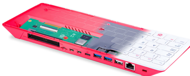
Rysunek 2. Widok konstrukcji wewnętrznej
