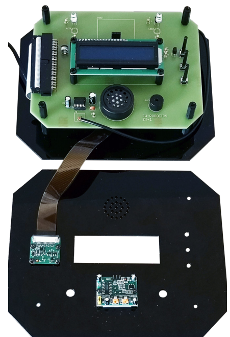
Fotografia 4. Montaż płytki drukowanej oraz przygotowanie górnej części obudowy
