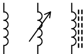
Rysunek 1. Symbole elektryczne popularnych elementów indukcyjnych
