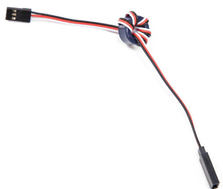
Fotografia 13. Dławik przeznaczony do filtracji zakłóceń
