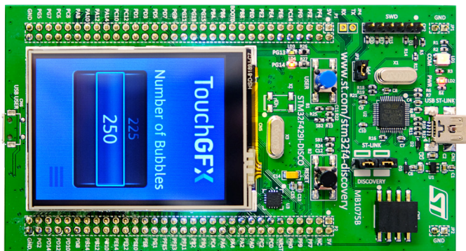
Fotografia 1. Program testowy uruchomiony na module STM32F429I Discovery
