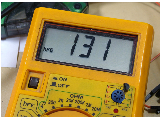
Fotografia 1. Pomiar parametru hFE tranzystora 2N3904 miernikiem Metex
