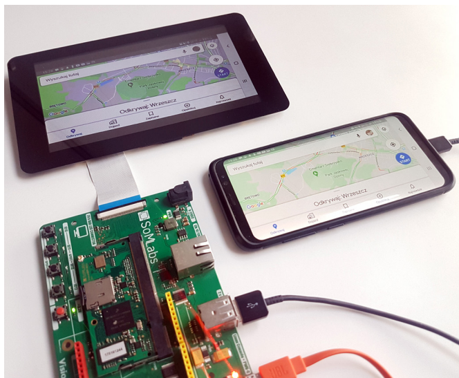
Fotografia 3. Funkcja Screen Mirroring zbudowana z wykorzystaniem pakietów ADB oraz Gstreamer
