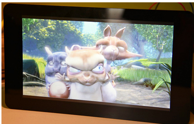
Fotografia 2. Wyświetlenie filmu testowego z wykorzystaniem wtyczki imxpxpvideosink
