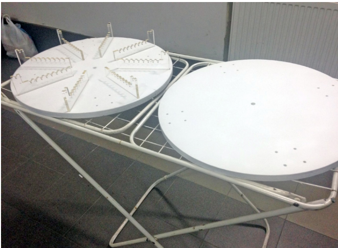
Fotografia 16. Elementy podstawy uzwojenia pierwotnego
