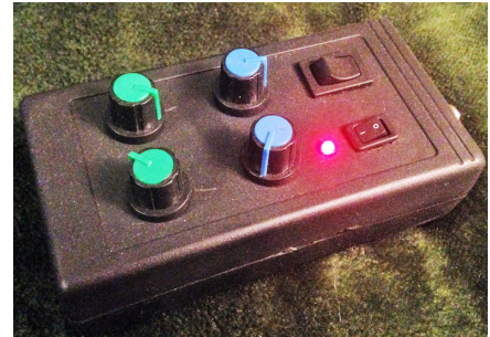
Fotografia 4. Interrupter – moduł kontrolujący parametry pracy cewki
