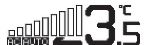
Rysunek 12. Wygląd graficznego interfejsu użytkownika urządzenia Climatic II w trakcie regulacji prędkości wentylatora
