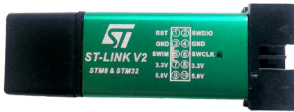
Fotografia 1. Programator-debugger kompatybilny z ST-LINK/V2 zastosowany w projekcie
