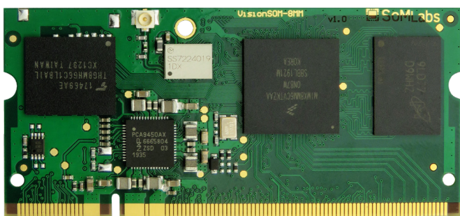
Fotografia 1. Wygląd modułu VisionSOM-8Mmini z pamięcią Flash eMMC
