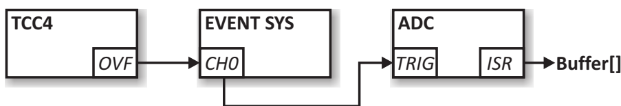
Rysunek 2. Schemat blokowy systemu akwizycji danych
