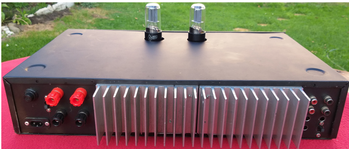
Fotografia 1. Konstrukcja tylnej ścianki obudowy wzmacniacza
