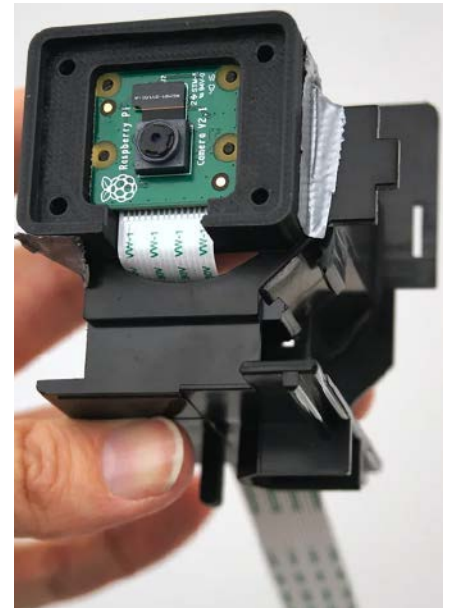
Fotografia 3. Moduł kamery w wydrukowanej w 3D obudowie
