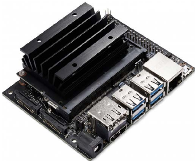
Fotografia 4. NVIDIA Jetson Nano to zestaw rozwojowy z układem graficznym Maxwell składającym się z 128 rdzeni wspierającym technologię CUDA. Przeznaczony jest zwłaszcza do przetwarzania bardzo dużych ilości danych lub obrazu i zapewnia odpowiednią wydajność do uruchamiania nowoczesnych rozwiązań AI w małym, energooszczędnym formacie
