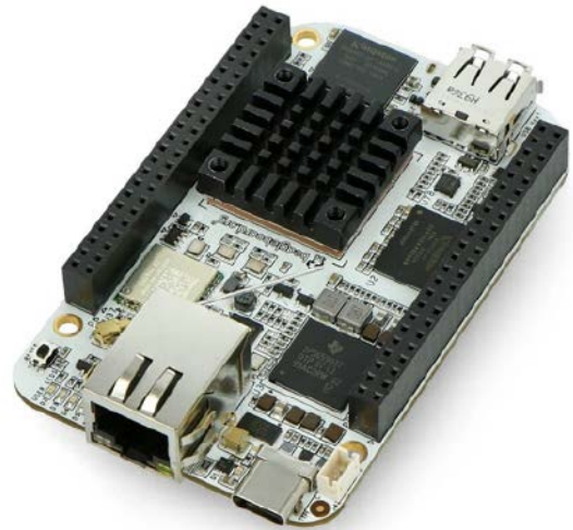
Fotografia 2. Minikomputer BeagleBone AI z procesorem Texas Instruments Sitara AM5729. Algorytmy sztucznej inteligencji mogą być implementowane dzięki bibliotece TIDL udostępnionej przez producenta
