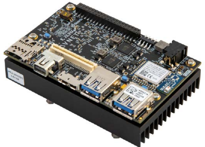
Fotografia 3. Płyta Ultra96-V2 wyposażona w układ Xilinx Zynq UltraScale+ oferuje inżynierom bardzo konkurencyjną cenowo platformę rozwojową do szybkiego prototypowania m.in. w zakresie sztucznej inteligencji
