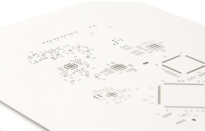
Fotografia 6. Szablon do nakładania pasty lutowniczej na arkusz cienkiej blachy stalowej z otworami wyciętymi laserem
