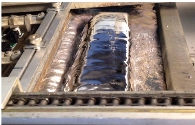
Fotografia 9. Strumień roztopionego spoiwa do lutowania na fali
