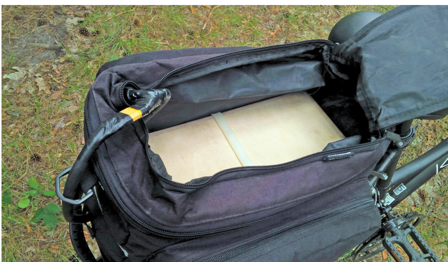
Fotografia 9. Akumulator zamontowany w torbie na bagażniku
