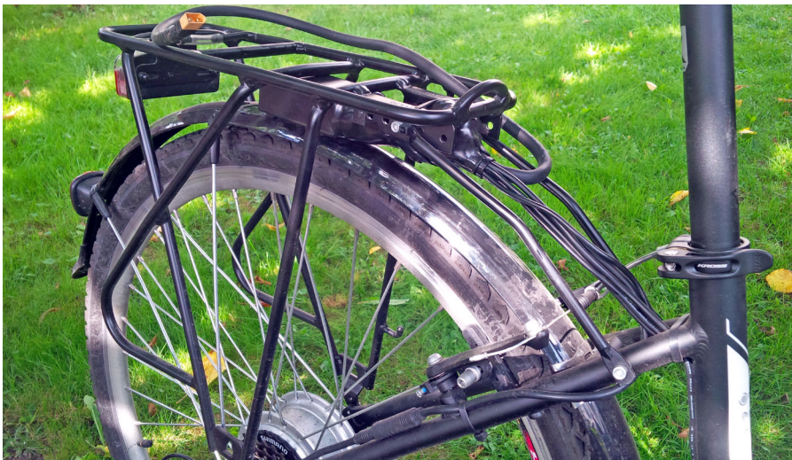
Fotografia 8. Sterownik zamontowany pod bagażnikiem
