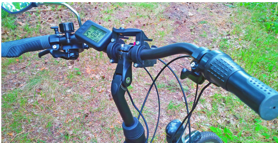
Fotografia 1. Kierownica roweru po konwersji, z zamontowaną manetką i komputerem pokładowym
