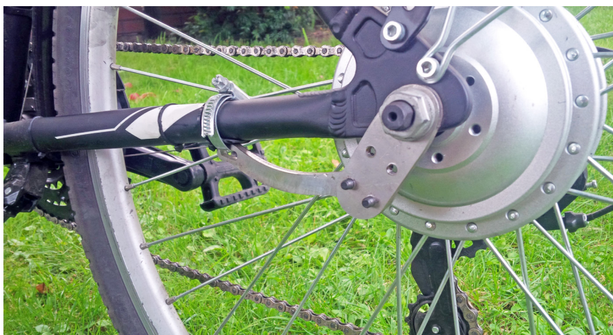
Fotografia 3. Zamontowana blokada obrotu osi silnika
