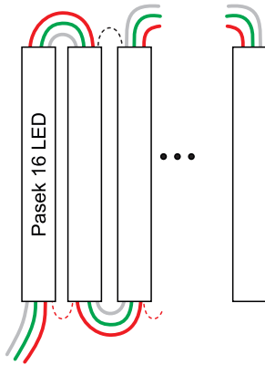
Rysunek 13. Sposób połączenia pasków diodowych dla zademonstrowania możliwości urządzenia
