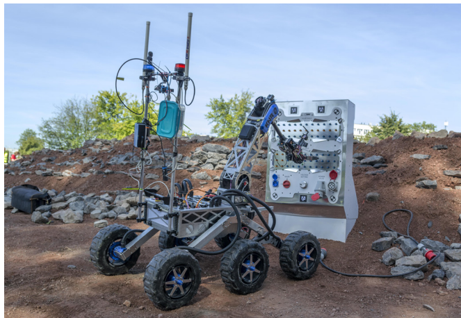
Fotografia 6. Łażyk z zamontowanym modułem komunikacyjnym na zawodach ERC
