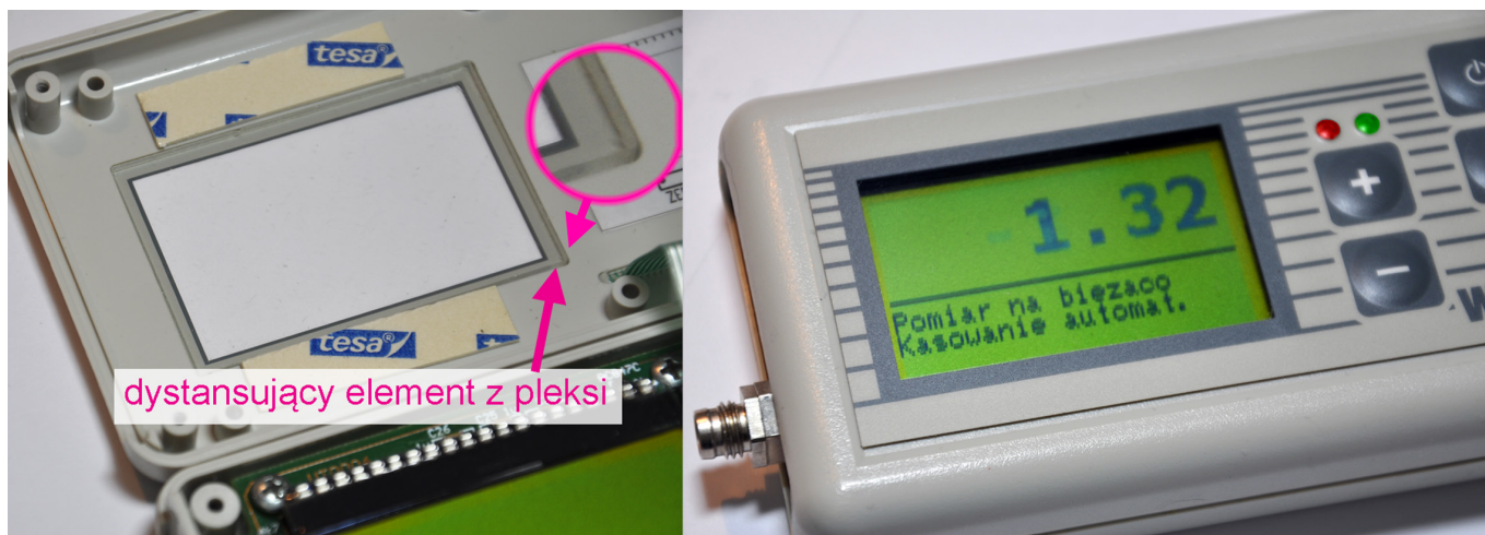
Fotografia 7. Płytką dystansującą z pleksi nad wyświetlaczem na klawiaturze foliowej
