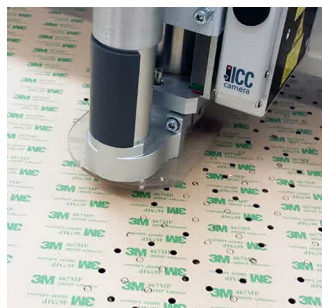
Rysunek 6. Błona klejowa w płocie tnącym podczas wycinania elementów samoprzylepnych (konwertingu) do dalszego zastosowania
