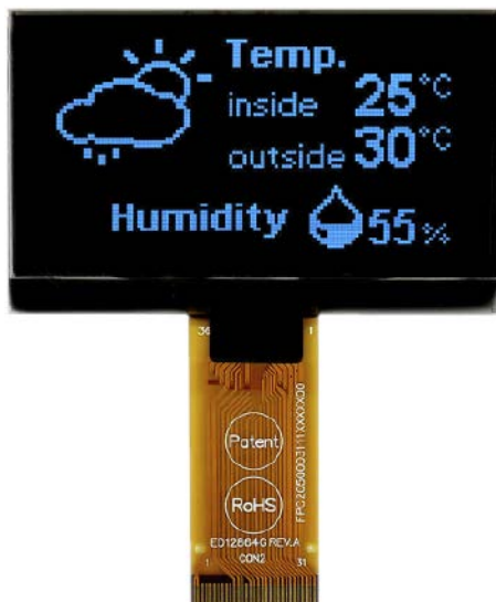
Fotografia 2. Wyświetlacz OLED serii WEO012864G od Winstara o przekątnej 2,42 cala
