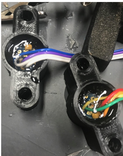
Fotografia 4. Sensor zalany żywicą w obudowie
