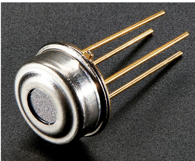
Fotografia 1. Zintegrowany termometr bezdotykowy MLX90614
