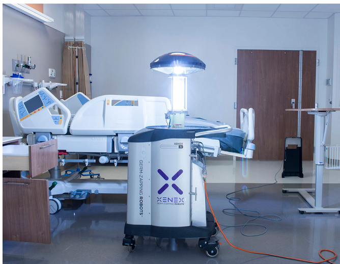
Fotografia 3. Robot dezynfekcyjny Xenex LightStrike
