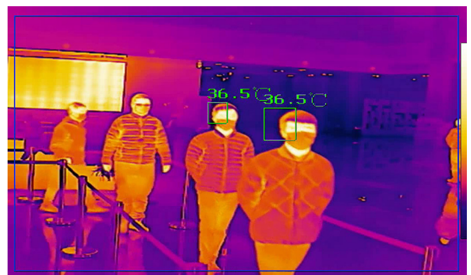
Fotografia 2. Obraz kamery termowizyjnej firmy HikVision, wyposażonej w system identyfikujący temperaturę ludzi
