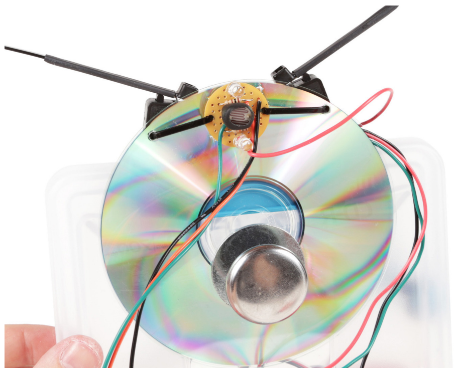
Fotografia 8. Sensor krawędzi zamontowany w robocie
