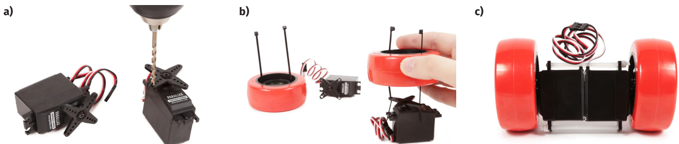
Fotografia 1. a) sposób rozwiercenia otworów montażowych w krzyżakach napędowych serwo silników; b) serwo silniki z zamontowanymi kołami; c) Kompletny moduł napędowy złożony z dwóch silników
