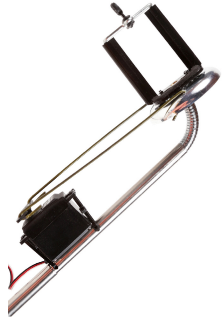
Fotografia 3. Sposób montażu smartfona w uchwycie z cięgnami
