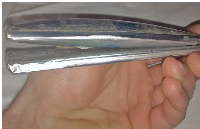
Fotografia 2. Dwa ogniwa pryzmatyczne, jedno spuchnięte
