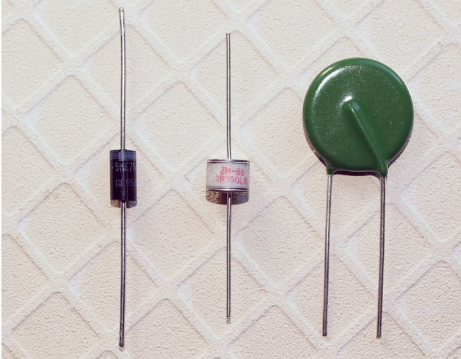
Fotografia 2. Składowe elementy ograniczników
