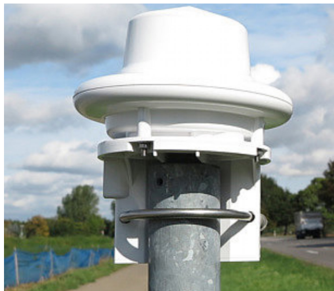
Fotografia 15. Radarowy czujnik opadu WS100 firmy Lufft
