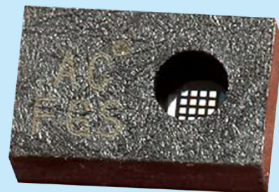
Fotografia 3. Czujnik typu AS7341 - 11-kanałowy sensor wielospektralny
