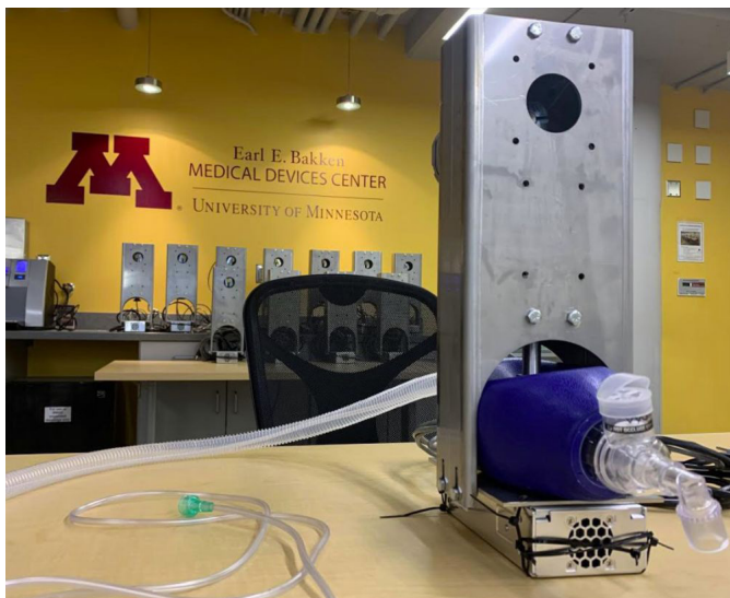
Fotografia 4. Respirator opracowany na University of Minnesota
