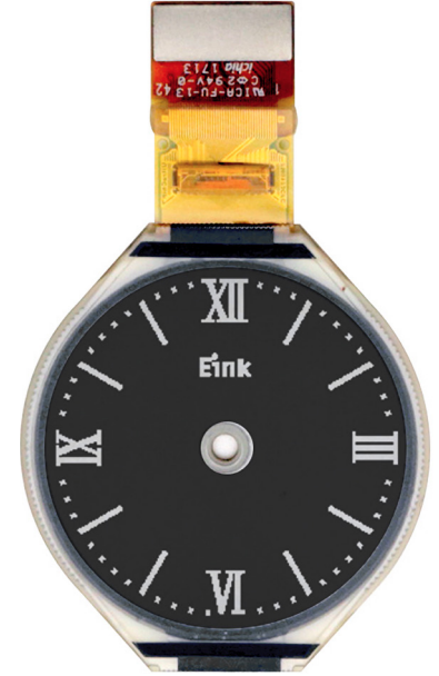
Fotografia 9. Wyświetlacz o okrągłym polu odczytowym ET011TJ2 (za notą E Ink)
