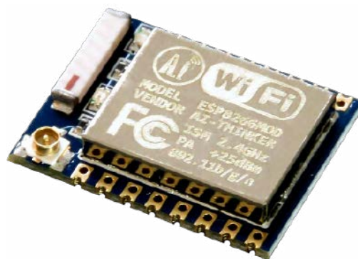
Fotografia 5. Moduł ESP-07 jako przykład produktu wyposażonego w antenę SMD oraz gniazdo u.FL (widoczne dwufunkcyjne pady lutownicze, zarówno wspierające montaż SMT, jak i zapewniające możliwość wlutowania goldpinów w rastrze 2 mm)
