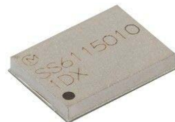
Fotografia 10. Subminiaturowy moduł Wi-Fi + Bluetooth 5.1 typu 1DX marki Murata ( https://bit.ly/3ewXrlg )
