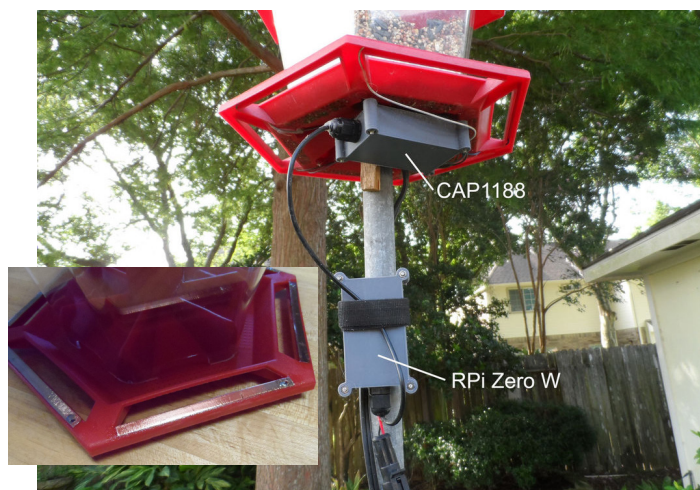
Fotografia 4. Karmnik uzbrojony w przewodzące taśmy do sensorów pojemnościowych
