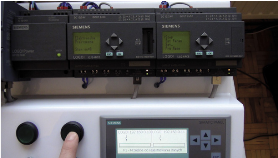
Fotografia 3. Lampka sterowana z wyjścia Q1 sterownika slave nie świeci
