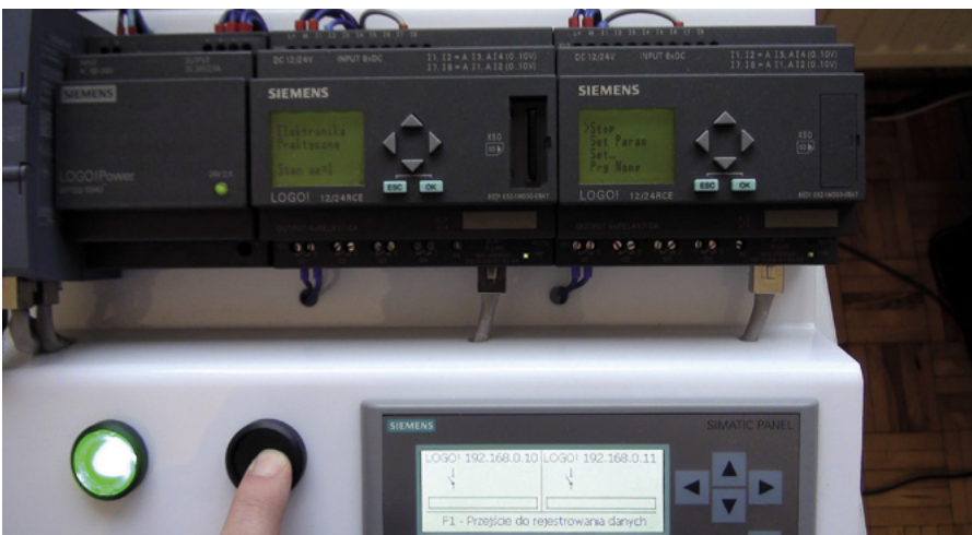
Fotografia 4. Lampka sterowana z wyjścia Q1 sterownika slave świeci
