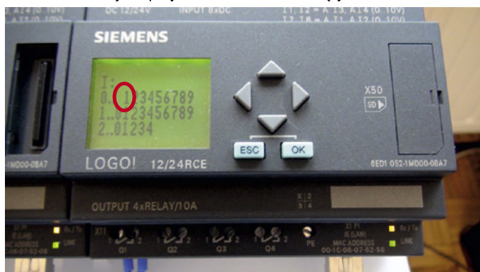
Fotografia 5. Zmiana stanu wyjścia Q1 w masterze w chwili przyciśnięcia przycisku dołączonego do I1 slave'a
