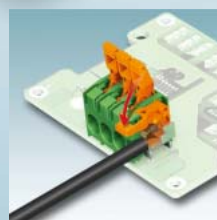
Przyłączanie przewodu giętkiego bez tulejki.
