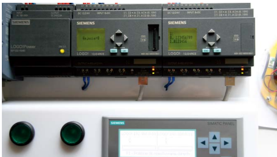
Fotografia 3. Zgaszenie lampki sterowanej za pomocą wyjścia Q1
