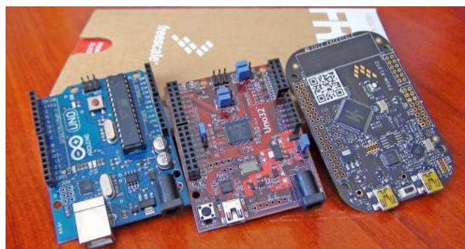
Fotografia 3. Zestaw FREEDOM jest zgodny mechanicznie z systemem Arduino (na zdjęciu porównanie płytek różnych komputerów zgodnych z systemem Arduino: Arduino Uno, Uno32 oraz FREEDOM)
