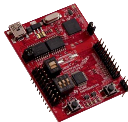
Fotografia 10. Zestaw C2000 Piccolo LaunchPad (LAUNCHXL-F28027)
