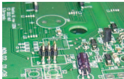
Fotografia 3. Sposób montażu złącza programatora: a) wciśnięcie w płytkę, b) przylutowanie, c) dosunięcie osłony.
