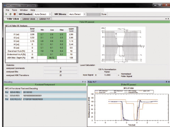
Rysunek 3. Ekran oprogramowania FS-K112PC w trakcie testowania urządzenia odpytującego zawiera m.in. listę transmitowanych komend, czasy narastania i opadania napięć oraz wskaźnik modulacji
