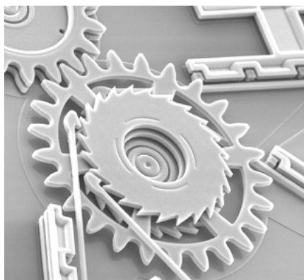
Fotografia 2. Jedna z wielu możliwych konfiguracji przekładni wykonanej w technologii MEMS
