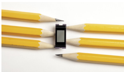
Fotografia 4. Wygląd systemu mikroluster DLP stosowanych w projektorach
