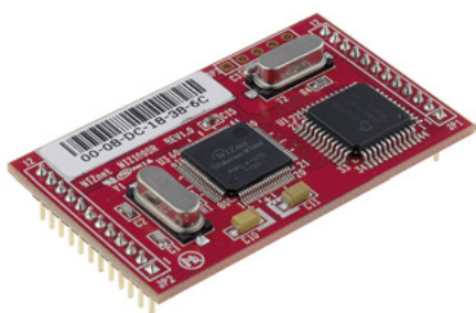
Fotografia 2. Moduł sieciowy (konwerter RS232) WIZ100SR
