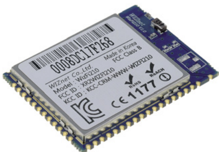
Fotografia 4. Moduł WiFi typu WizFi 210 (wariant z anteną SMD)
