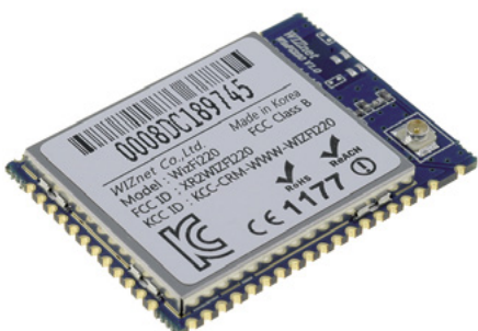
Fotografia 5. Moduł WiFi typu WizFi 220 (wariant z gniazdem antenowym)
