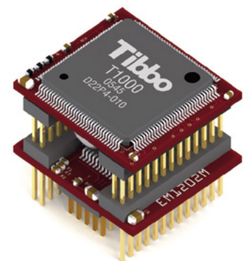
Fotografia 10. System z modulem EM1202
