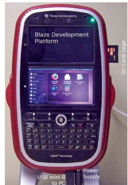
Rysunek 1. Urządzenie do testowania możliwości i tworzenia oprogramowania dla platformy OMAP 4 (źródło: www.omappedia.org )
